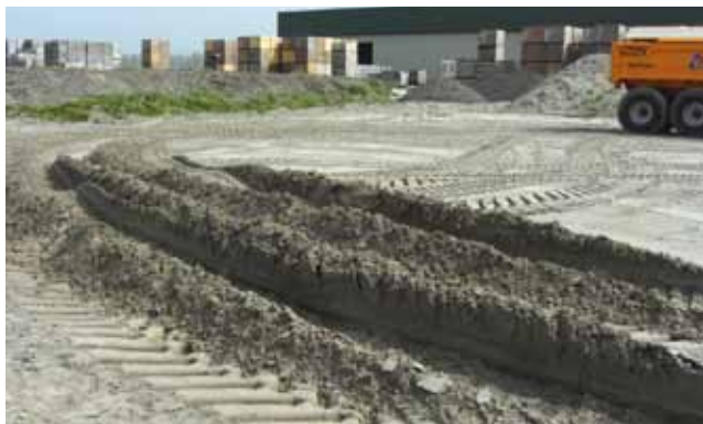
Af en toe bulldozerden de banden van de drieasser door de zandlaag, om er daarna toch weer bovenop te komen. De New Holland trok de kipper erdoor zonder dat de liftasfunctie werd gebruikt.
