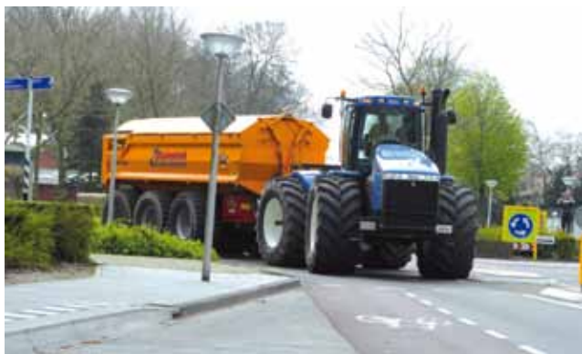
De besturing van de combinatie bleek wonderwel te werken. De ultieme proef, rechtsaf op de rotonde, verliep vrijwel zonder wringen.
