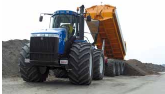
De eigen hydrauliek van de kniktrekker bleek niet in staat om de bak boven te krijgen. Met wat extra olie ging het voor één keer wel.
